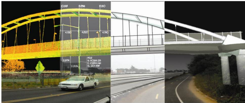
Общий вид 3D модели Андреевского пешеходного моста, построенной по результатам 3D сканирования www.ngce.ru
