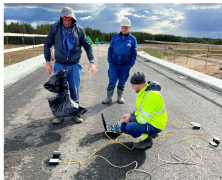
Рис. 2.10. Измерение величины раскрытия трещин в поврежденной балке.
