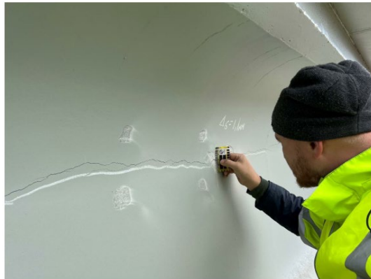
Рис. 2.10. Измерение величины раскрытия трещин в поврежденной балке.
