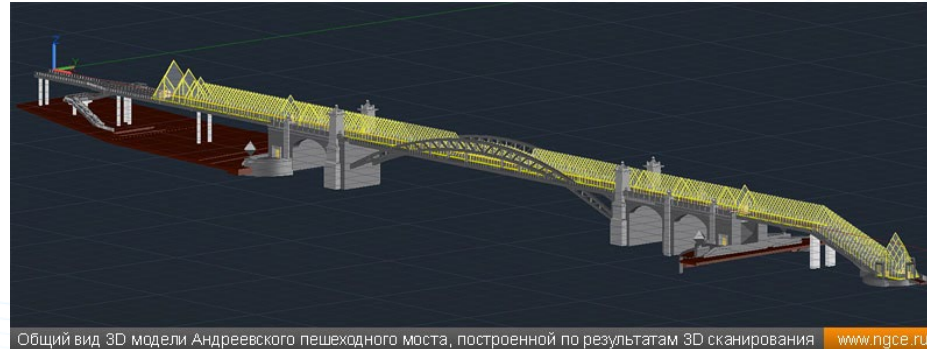
Общий вид 3D модели Андреевского пешеходного моста, построенной по результатам 3D сканирования www.ngce.ru
